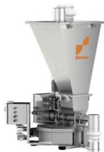
ST/SS 系列失重式螺杆喂料器包含六种型号：ST11/SS45, ST22/SS45, ST36/SS72, ST48/SS96, ST65/SS123, ST80/SS160。该系列喂料器是根据失重工作原理对物料进行连续计量。典型产量范围:0.3~5000kg/h(易流动的颗粒原料) 0.1~3000kg/h(不易流动的粉状原料)
