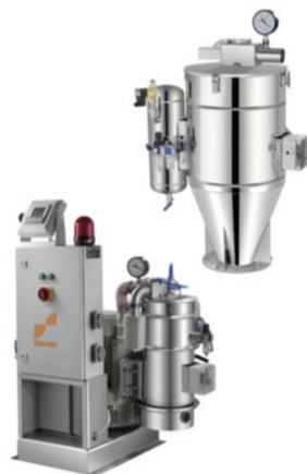
FC 原料输送机是一款自动输送原料的输计量采用稀相真空负压传送原理，既可以单机输送，将原料从储料仓输送到生产线；又可以采用中央式输送，集中管路系统将原料从储料仓输送到每条生产线的主机上，产量范围：1 ~ 2000 kg / h
